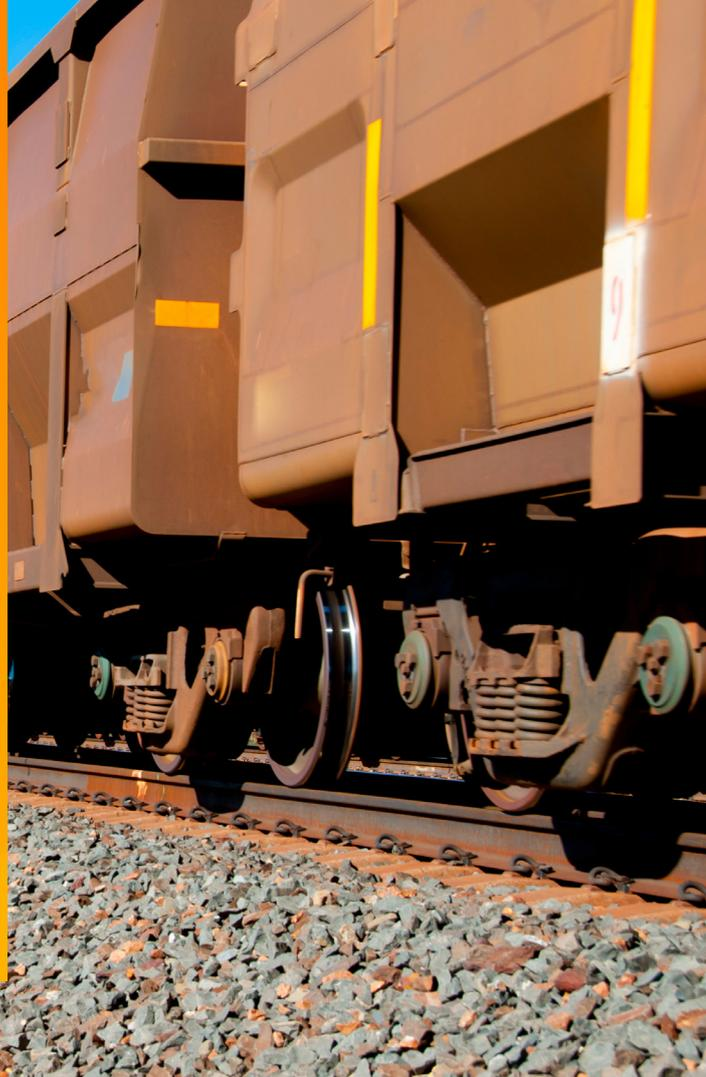
**Pacific National erfasst und verarbeitet Hochgeschwindigkeitsbilder von Radsätzen, um wichtige Messwerte für die Zustandsüberwachung zu ermitteln. Das Unternehmen hat Versor, ein Unternehmen der Fujitsu Gruppe, beauftragt, eine KI-gestützte Lösung zu entwickeln, die die Verschleißmerkmale von Wagen- und Lokomotivrädern berechnet und anhand dieser Messwerte optimal und schlecht verschleißende Fahrzeugradsätze identifiziert.**
