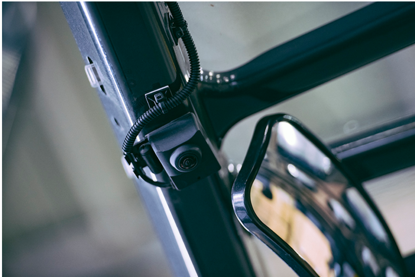
フォークリフトに取り付けられたドライブレコーダー
