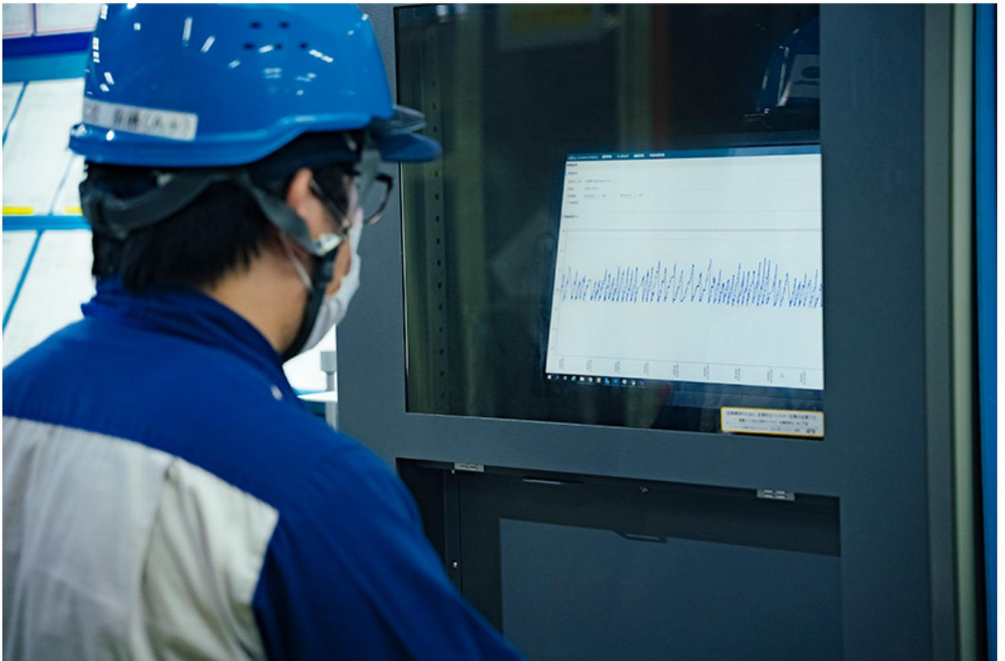
加工中の設備の各種センシングデータに基づいた品質予測値がモニターにプロットされる
