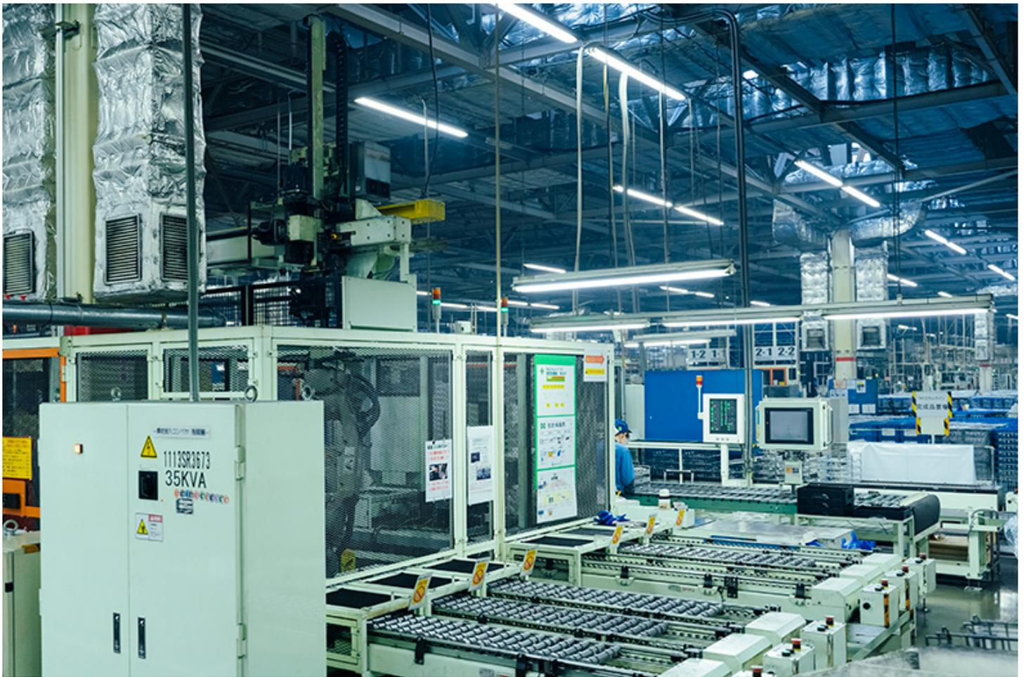
上部のローダーでカムシャフトを自動搬送し、研削加工含む約10工程を経て完成
