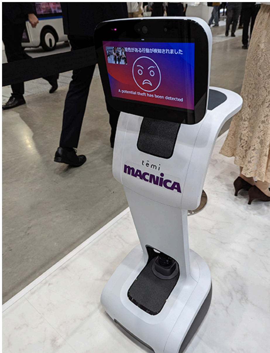
AIと連動したロボットが追跡してお声がけする仕組み
