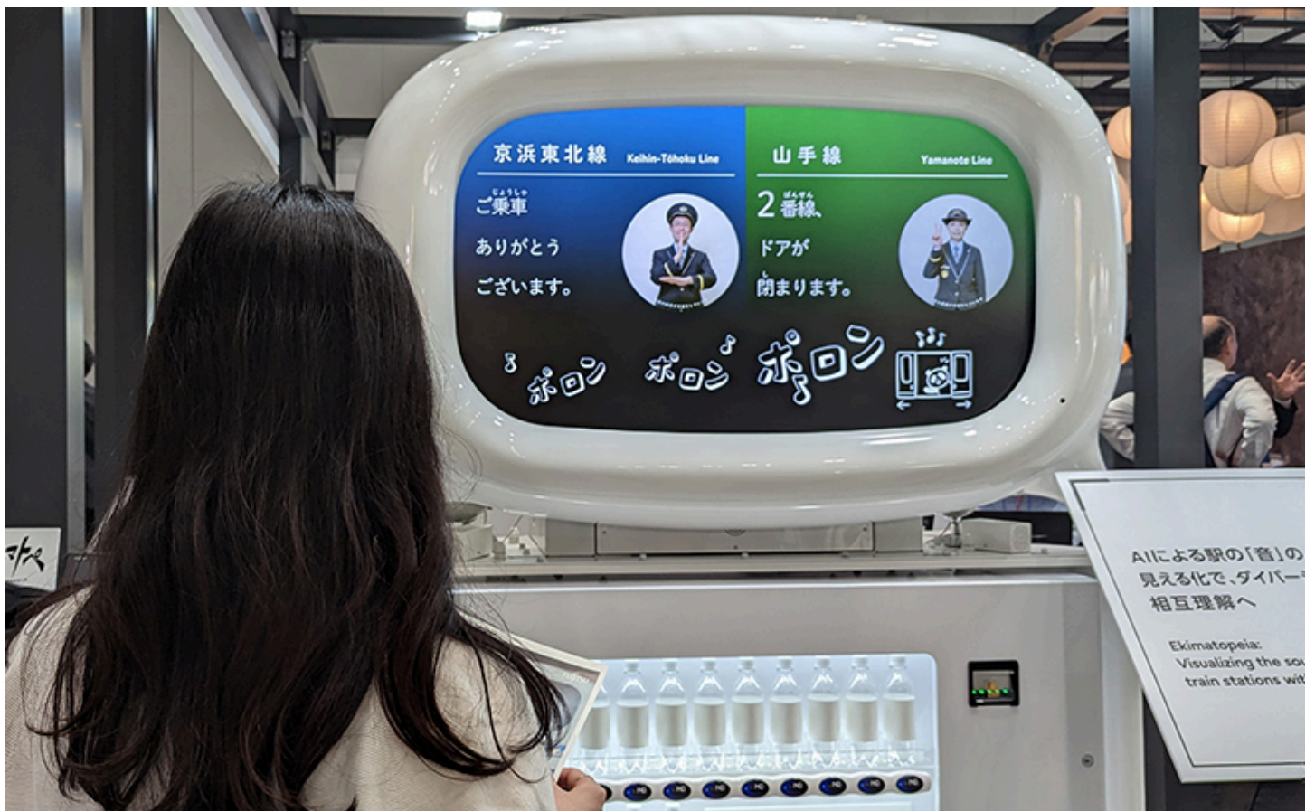
上野駅で設置されたエキマトペ 自販機の上に設置し、ホームの音を可視化している
