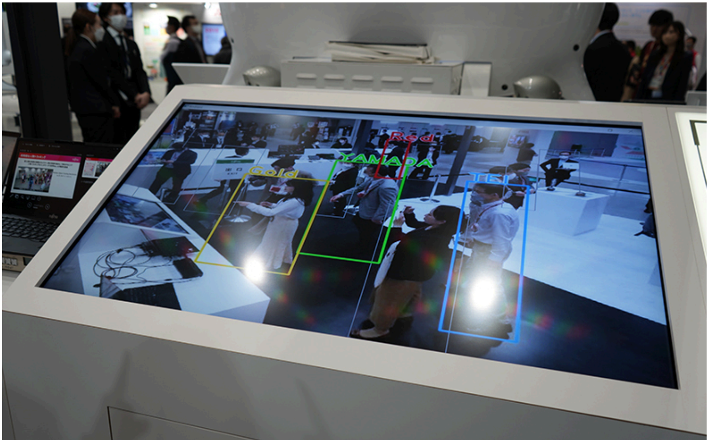
ブース中央のディスプレイ。入口付近のカメラで認識した来場者を特定し、色分けして表示
