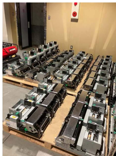
ATMの再生保守部品(ユニット)
