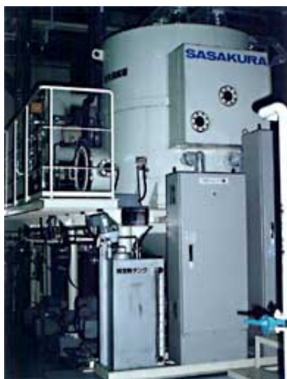
有機アルカリ廃液減圧濃縮装置による 廃液の減量化前と後(左の2本分から 右の1本分へ1/60に減量)
