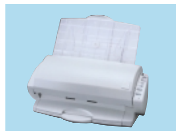
イメージスキャナ：VSP130 再資源化可能率…………… 95.9% 待機時の消費電力…………… 4.04W 25g以上プラスチック部品への材料表示
