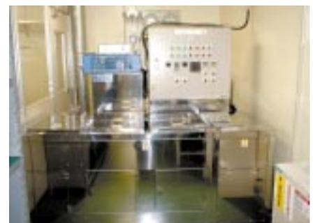
デバイス部品洗浄装置(FDKいわき工場)
