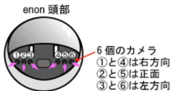
2.左右のカメラから撮った映像の特徴点を照合します。照合方法は、三角測量を用いて、特徴点とenon(エノン)までの距離などの位置を割り出します。
